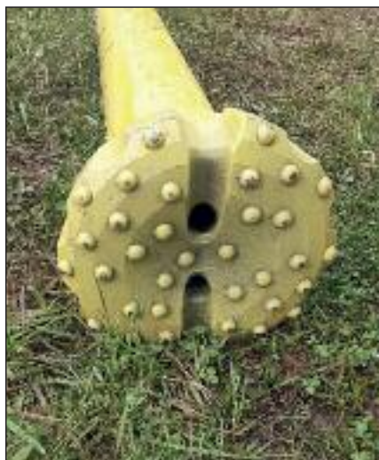
Ponorné kladivo, kterým byl vyhlouben vrt u vodojemu
